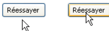
Figure 20 Exemple de changement d'état du bouton au passage de la souris et du focus (surbrillance de l'item sélectionné)
